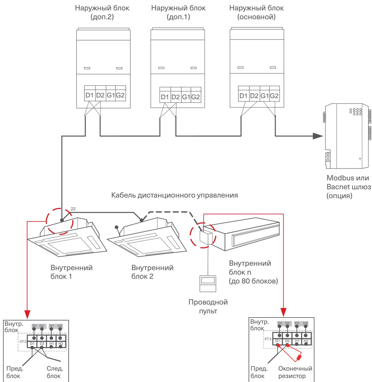
Внутренние и наружные блоки подключаются к разным источникам электропитания. Все внутренние блоки подключаются к одному источнику питания. В силовой цепи необходимо предусмотреть прерыватель замыкания на землю (УЗО) и автоматический выключатель защиты от токовых перегрузок.
