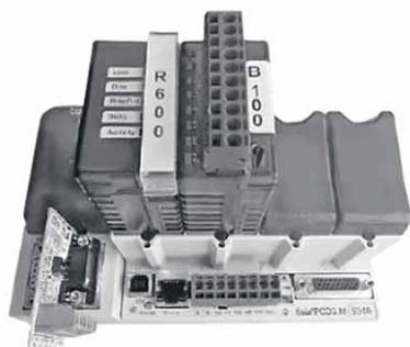
Интерфейсный шлюз для интеграции с **BACNET SIU31G1** применяется в системе Energolux для интеграции в открытую систему управления зданием (BMS) на базе протокола Bacnet для получения централизованного и дистанционного управления системой.
