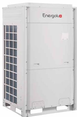
Суммарная длина трубопроводов хладагента может достигать 1000 метров, перепад высот между наружным и внутренними блоками – 90 метров, а максимальное удаление внутреннего блока от наружного – 165 метров.
